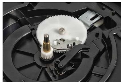
Mechanizm sterujący ramieniem jest umieszczony częściowo pod talerzem, a częściowo wbudowany wewnątrz plinty.
